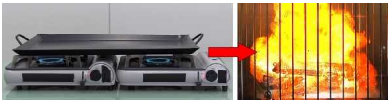
カセットコンロを2台並べて使用して破裂
